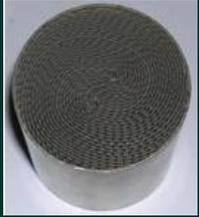
el catalizador se dispone en una capa de washcoat cuyo espesor es del orden de los micrones
