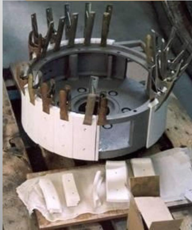
*Tejas de alúmina reforzadas con fibras del mismo material utilizadas en servicio de alta abrasión.*
