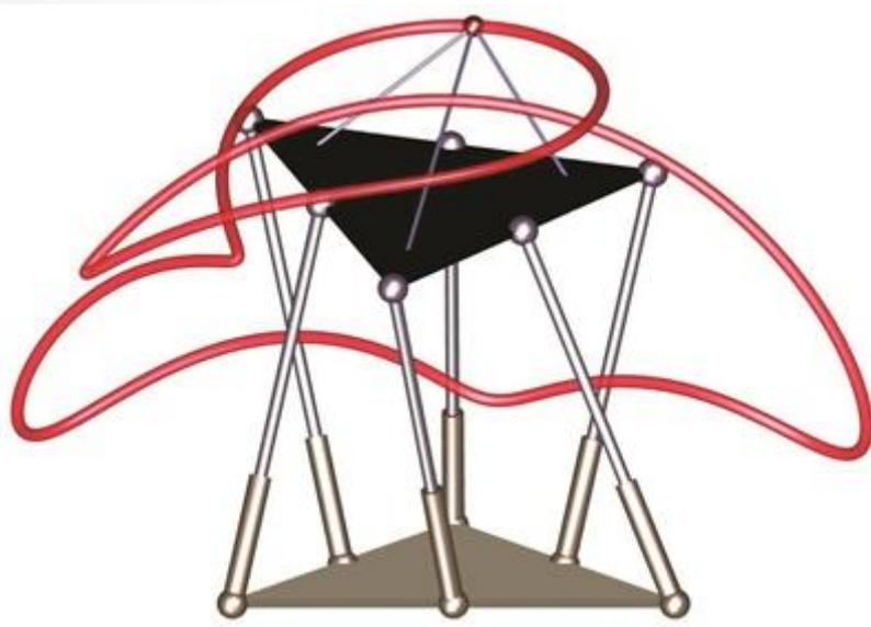
Es importante evitar las **singularidades** en el movimiento del robot para que no se rompa... y las singularidades se detectan con el **discriminante** de las ecuaciones que definen las posibles trayectorias.
