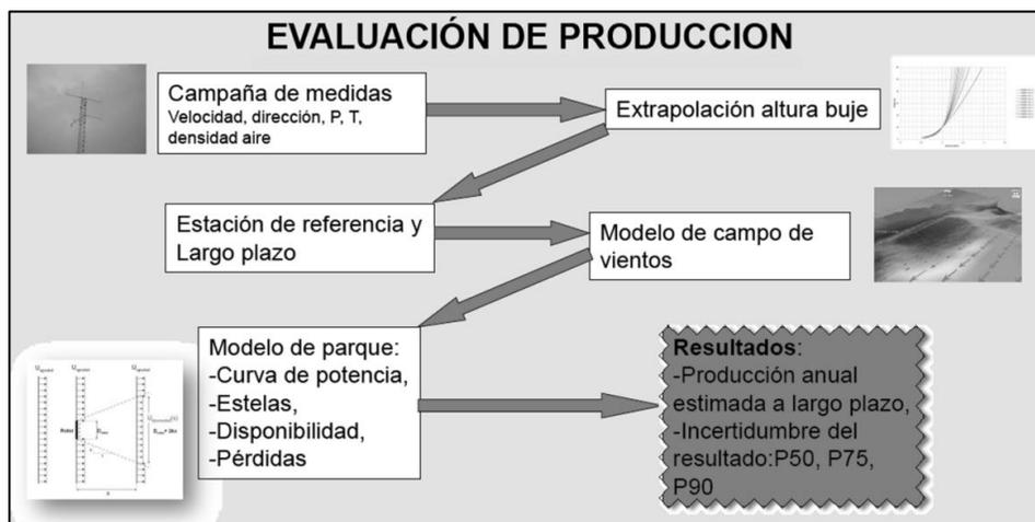
Fig. 7. Síntesis esquemática de los procesos a realizarse en la estimación de la generación de energía de un parque eólico.
